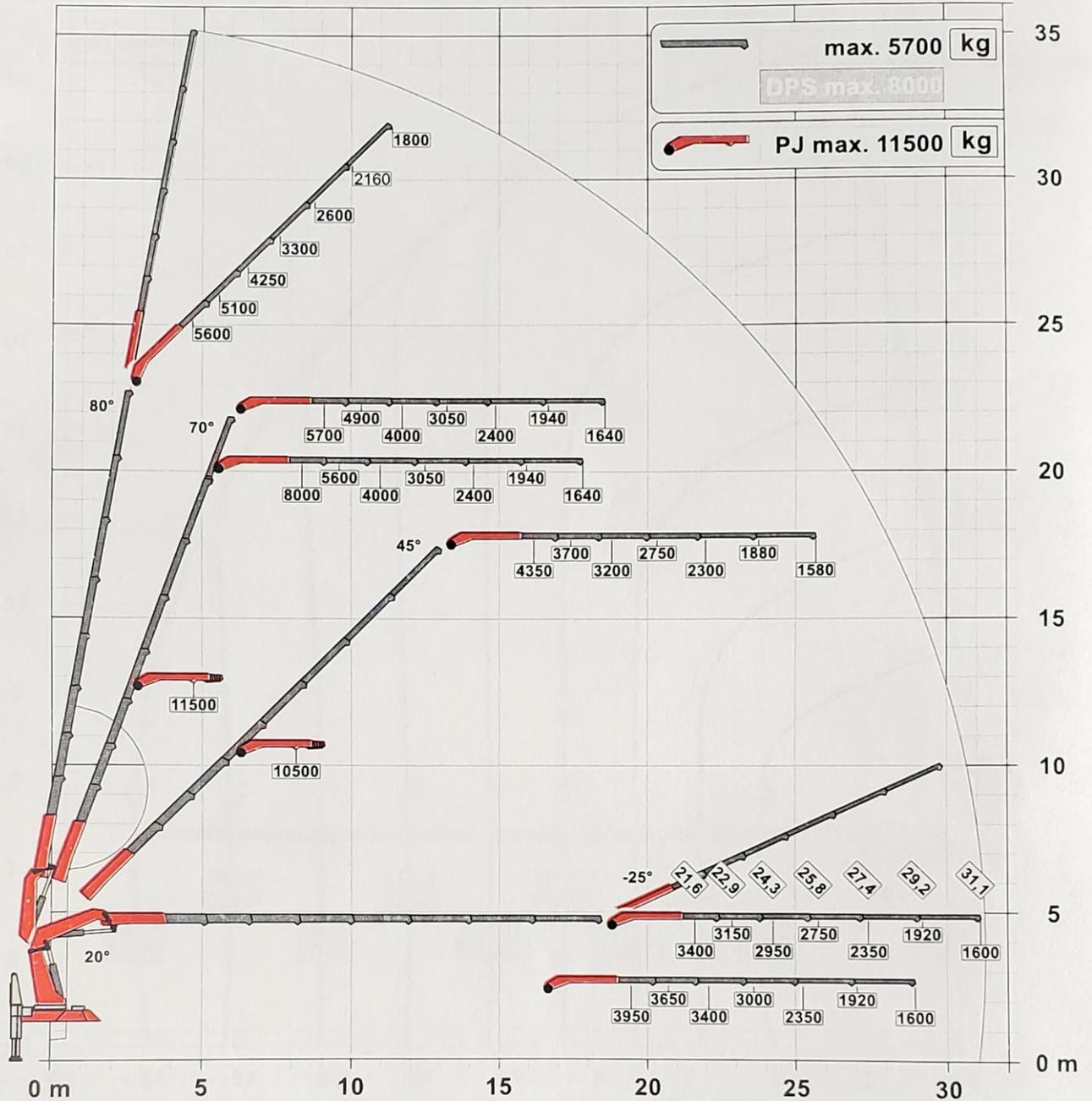
Die Tragkräfte laut Diagramm verringern sich bei Verwendung von Schlauchrüstung am Fly-Jib.
